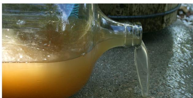
▲ La couleur, l'odeur et la transparence sont des paramètres faciles à contrôler ; ils sont ainsi très utiles pour détecter les problèmes. (Source: Ildar Sagdejev/CC BY-SA 4.0)
